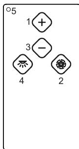
**1: + motor****2: On/Off motor****3: - motor****4: On/Off light****5: Led**
